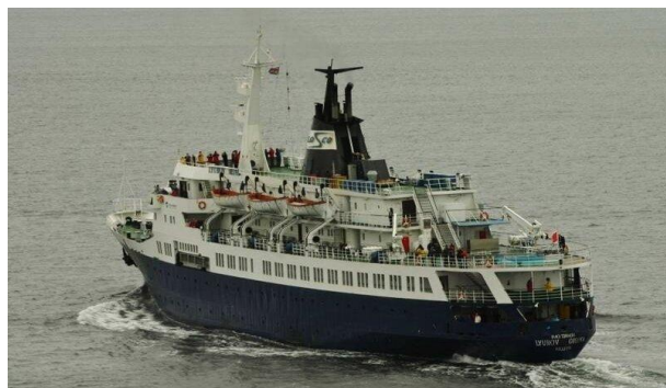
Рис. 44. Пассажирский лайнер «Любовь Орлова» без широкой транцевой кормы – обладает плавной качкой с прогнозируемой интенсивностью.
