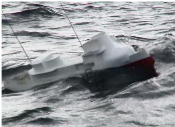
Рис. 92. А-1202 - Буксир-спасатель – научно-исследовательское судно. Испытание телеуправляемой модели в открытом море. Слева модель поднимается по склону набегающей волны, опасного отката с обратным движением не фиксируется. Справа, модель с округлыми обводами сопровождают несколько дельфинов с похожей формой тела.
