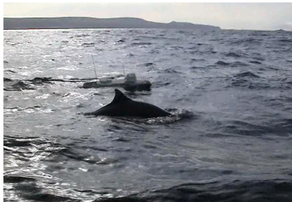
Рис. 92. А-1202 - Буксир-спасатель – научно-исследовательское судно. Испытание телеуправляемой модели в открытом море. Слева модель поднимается по склону набегающей волны, опасного отката с обратным движением не фиксируется. Справа, модель с округлыми обводами сопровождают несколько дельфинов с похожей формой тела.
