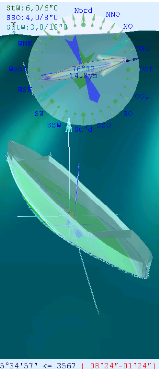
Рис. 24. Прорисовки динамического состояния корабля в двух графических окнах: в корабельном базисе и в морской системе координат. Показана картушка с текущим курсом и скоростью хода. Стрелками отмечается длина, крутизна и направления движения групповых структур волн. В нижней части графики бортовой, килевой и вертикальной качки, выше ходкость, рыскание и вертикальные ускорения в средней части корпуса и в оконечностях.
