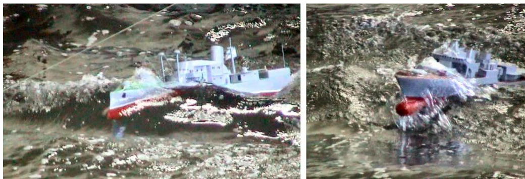
Рис. 6. Недопустимо, чтобы на курсе вразрез волны носовая часть корабля подвергалась чрезмерным силовым нагрузкам со стороны штормового волнения ( справа ). Это означает, что вместо подводного бульба и сильного развала скуловых шпангоутов корпус должен иметь подводный подрез форштевня и предельно минимальный объем надводного борта выше ватерлинии ( слева )
