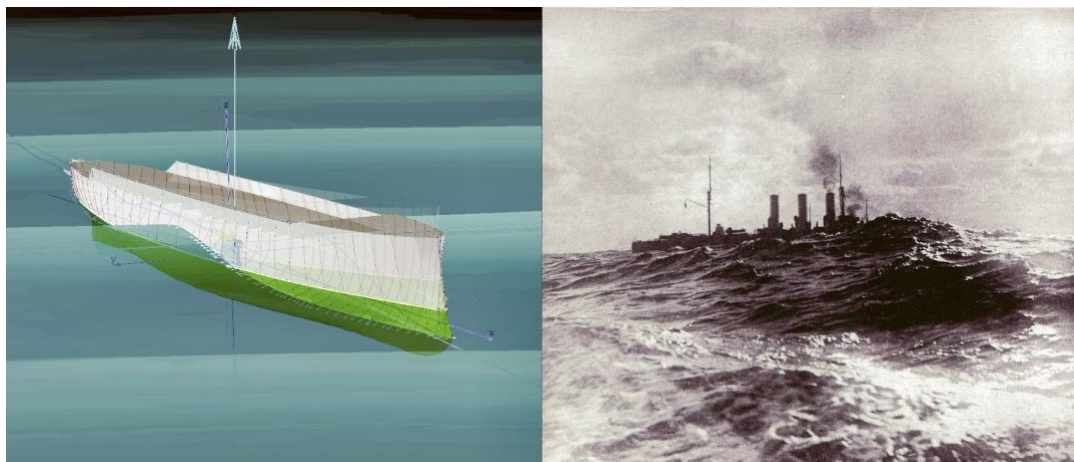
Рис. 5. Крейсер Аврора на ходу по штормовой волне ( справа ). Надводный объем корпуса относительно велик ( слева ), однако обводы в целом и форма надводного борта представляются наилучшими образцами инженерной практики моряков-корабелов начала XX века
