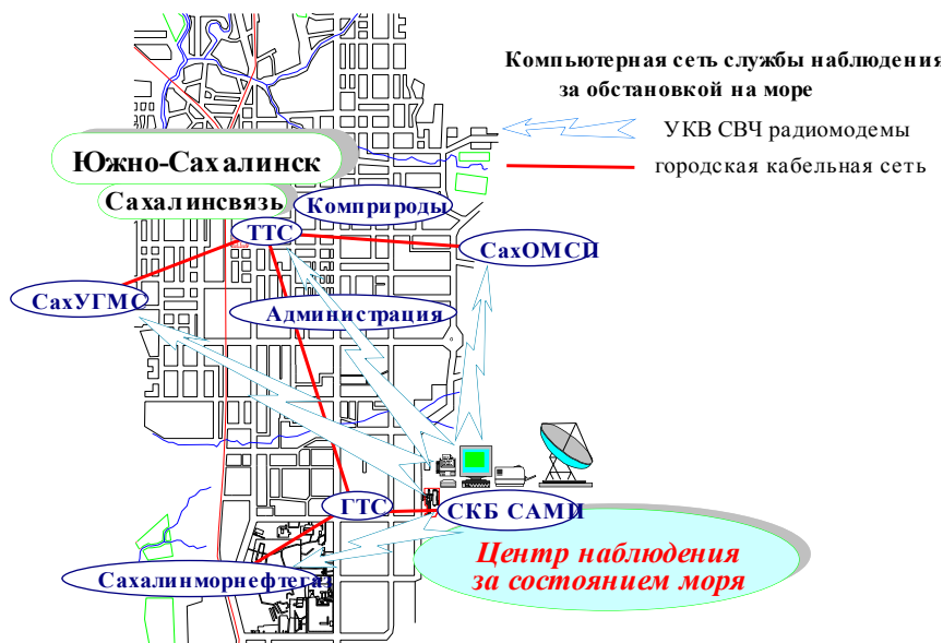
Рисунок 53. Южно-Сахалинский сегмент должен связать основные оперативные службы в единую компьютерную сеть с помощью высокоскоростных радиомодемов. В то же время каждый информационный ресурс должен быть включен в городскую кабельную сеть передачи данных, что обеспечит доступ к нему со стороны других потребителей информации.
