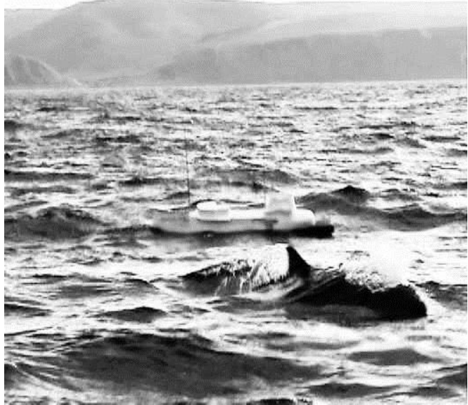
Рис. 1.10. Испытание телеуправляемого гидрографического модуля в открытом море
