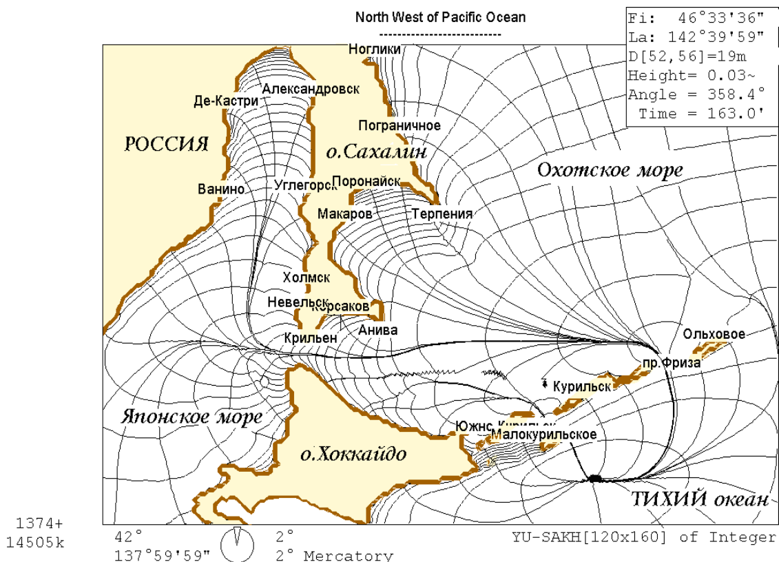
Рис. 3.3. На рисунке показана ортогональная сетка, составленная из лучей и фронтов волн для землетрясения и цунами 5 октября 1995 года.
