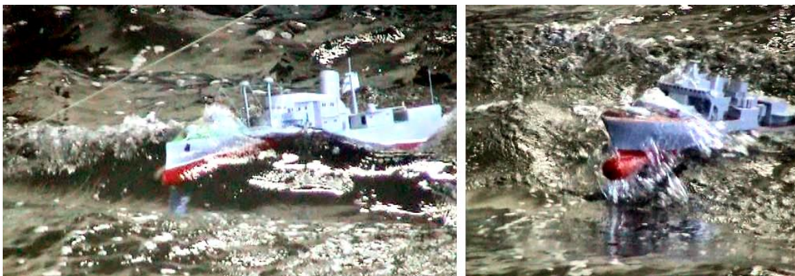
Рис. 49. Недопустимо, чтобы на курсе вразрез волны носовая часть корабля подвергалась чрезмерным силовым нагрузкам со стороны штормового волнения ( справа ). Это означает, что вместо подводного бульба и сильного развала скуловых шпангоутов корпус должен иметь подводный подрез форштевня и предельно минимальный объем надводного борта выше ватерлинии ( слева )
