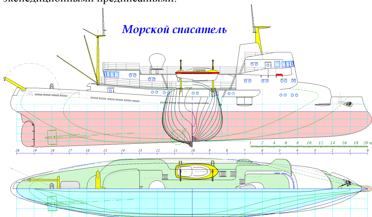
Рис. 79. Обводы и концептуальная схема общего расположения всепогодного океанского судна, способного обеспечивать эффективную работу палубной команды при активном маневрировании произвольными курсами относительно штормовых волн и ураганного ветра. L_{MAX} = 62,8 м; L_{KWL} = 60 м; B_{MAX} = 10,3 м; B_{KWL} = 10 м; T_{Нос} = 4 м; T_{Корма} = 6 м; H = 1,25 м; \delta = 0,58 ; W = 1740 м 3 ; S = 809 м 2 ; V \approx 16 узлов
