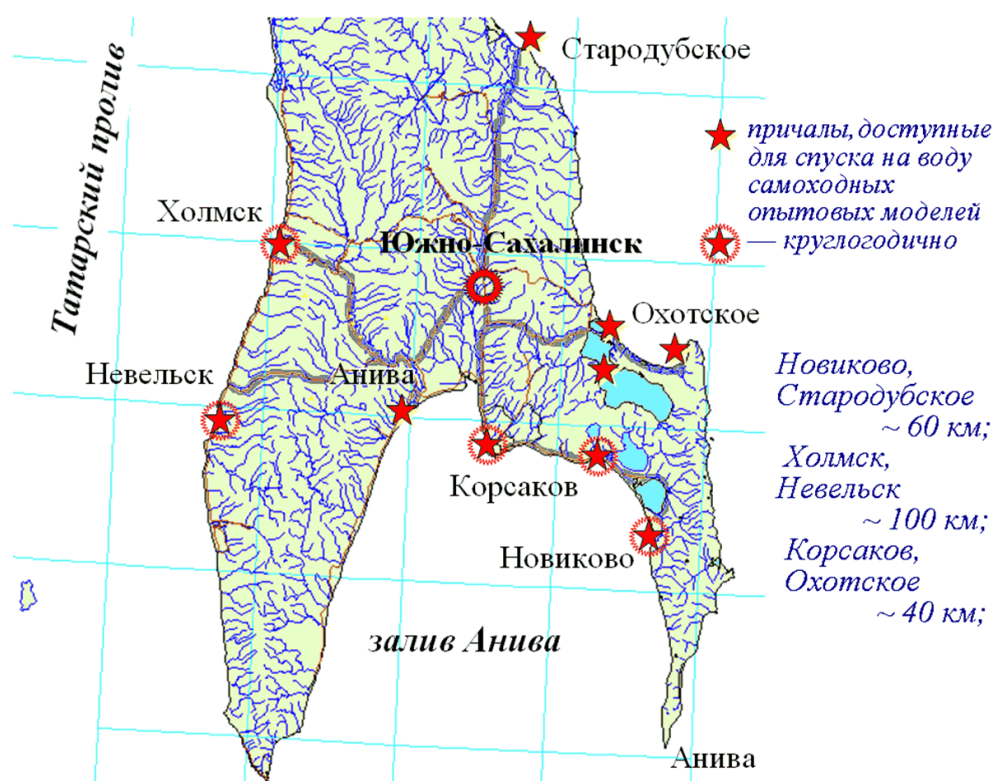
Рис. 87. Географическая карта южной части о-ва Сахалин с указанием автомагистралей и морских причалов для спуска на воду опытовых моделей судов
