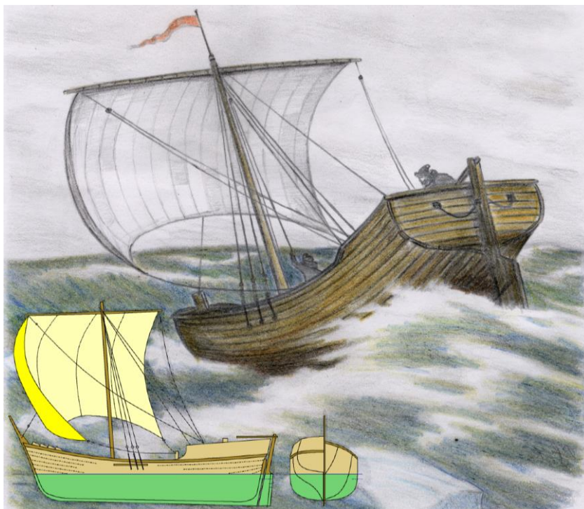
Рис. 5. Обводы корпуса учитывают особенности штормового плавания по волне под управлением штормовых парусов и навесного руля
