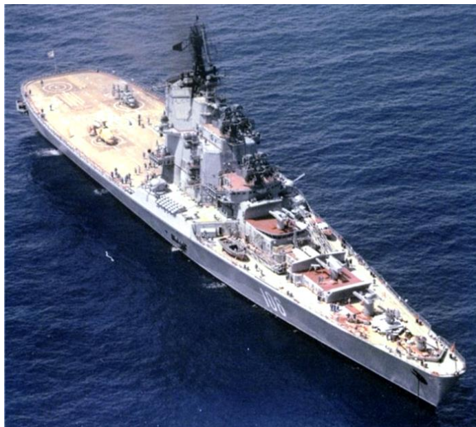
Рис. 21. Крейсер «Москва» имеет обводы в форме двойного клина и развал бортов вдоль всего корпуса корабля.
