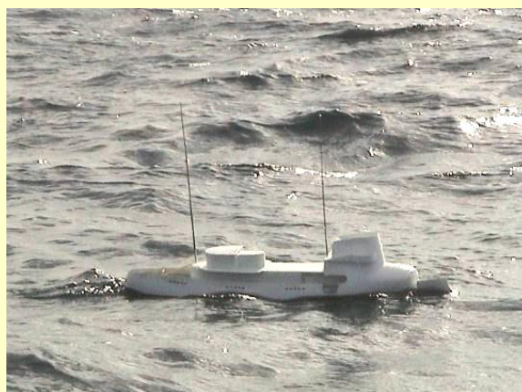
Рис. 78. Округлый корпус и низкие палубы судна уменьшают интенсивность всех видов штормовой качки на глубокой воде
