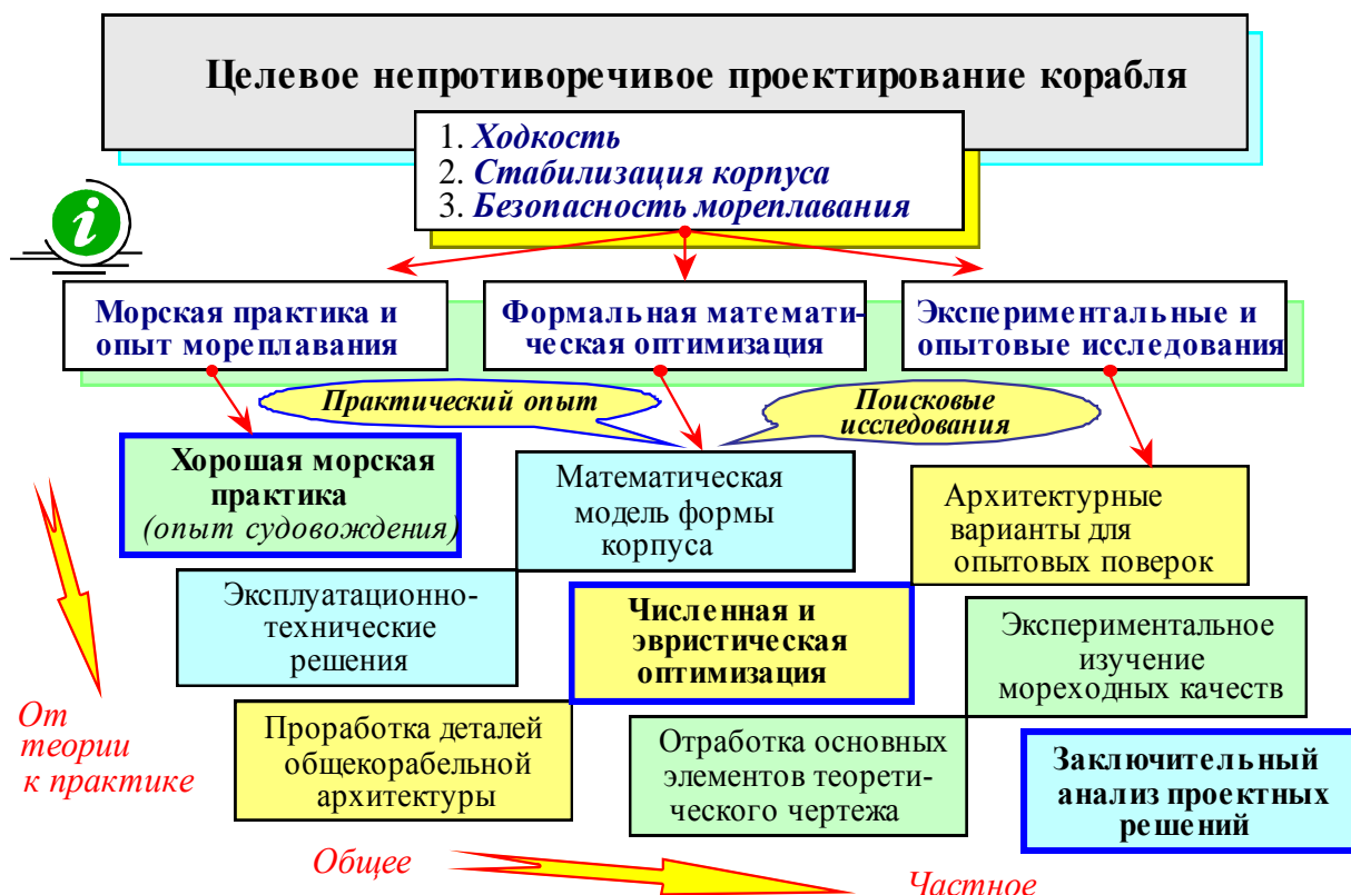
Рис. 1. Блок схема в форме троичного иероглифа по проектной схеме «сверху-вниз»: от обобщенных теоретических предпосылок к частным инженерно-техническим решениям. Столбцы матрицы попарно связаны исторически поверенными решениями задач морской практики (слева) и современными достижениями в области корабельной гидромеханики (справа). По строкам образуются уровни этапов адаптации инженерных решений в ограничениях технологических возможностей судостроения, изначально адаптированных к региональным условиям для достижения эффективности мореплавания в сложных, штормовых и ледовых условиях дальневосточных морей.
