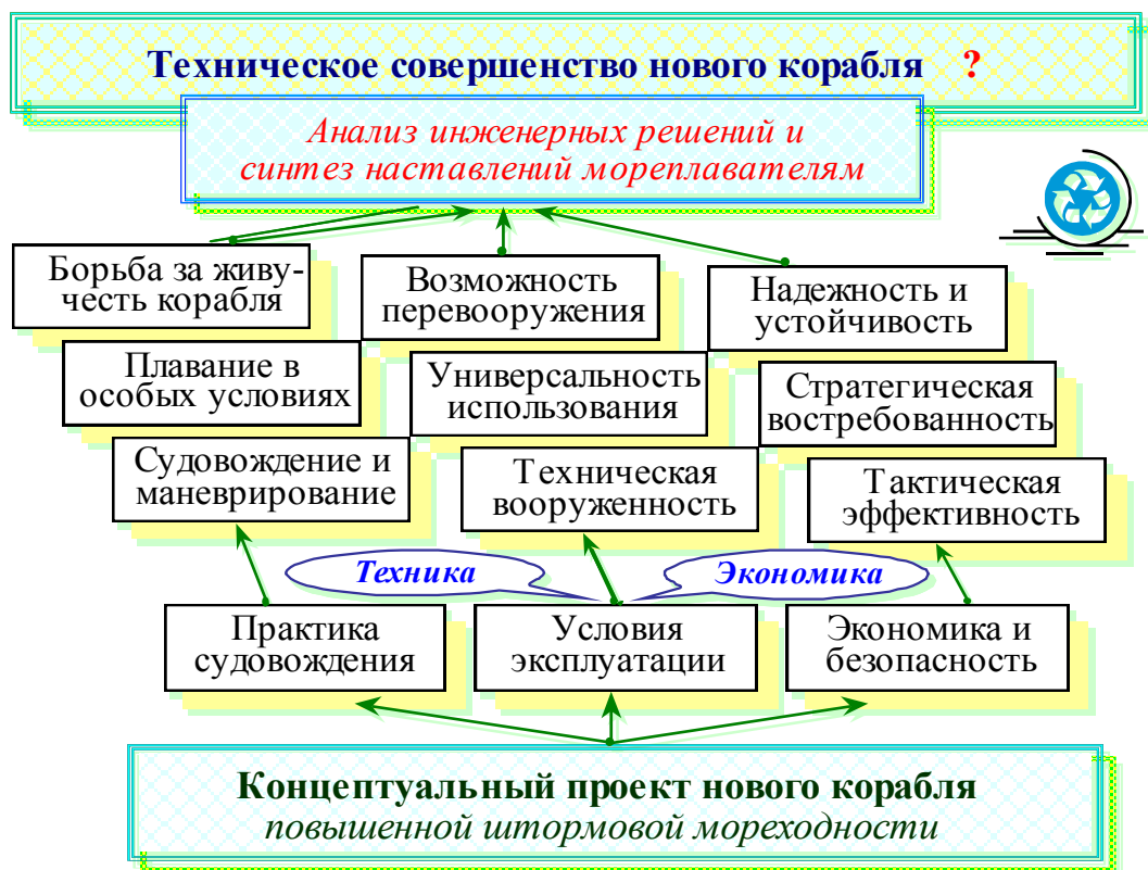
Рис. 2. Синтез заключений мореплавателей в поверочном комплексе проектных оценок в направлении «снизу-вверх»: от множества инженерных новаций - к технической эффективности и экономической оптимальности судна в конкретных навигационно-географических условиях. Как результат – возникает вопрос о техническом совершенстве нового судна, разрешаемый в контексте согласования всего комплекса наставлений мореплавателям.
