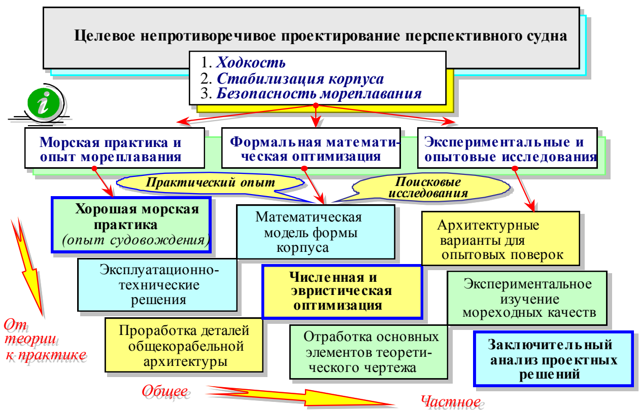
Рис. 7. Троичная матрица проектной схемы «сверху-вниз»: от теоретических обобщений к частным инженерным решениям. Столбцы матрицы попарно связаны исторически поверенными решениями задач морской практики (слева) и современными достижениями в области корабельной гидромеханики (справа). По строкам образуются уровни этапов адаптации инженерных решений в ограничениях технологических возможностей судостроения, изначально адаптированных к региональным условиям для достижения эффективности
