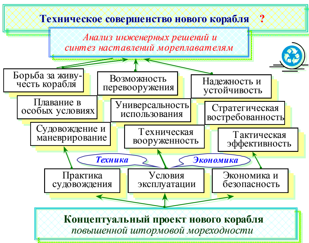
Рис. 8. Обратная матрица формализует синтез заключений мореплавателей в поверочном комплексе оценок в направлении «снизу–вверх»: от множества инженерных новаций - к технической эффективности и экономической оптимальности судна в конкретных навигационно-географических условиях. Как результат – возникает вопрос о техническом совершенстве нового судна в контексте согласования всего комплекса наставлений мореплавателям.
