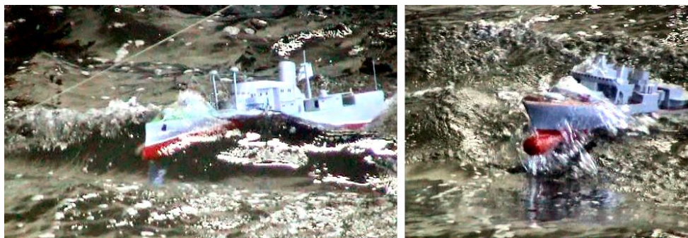
Рис. 6. На курсе врез волны носовая часть корабля подвергается чрезмерным силовым нагрузкам со стороны штормового волнения ( справа ), возникающими под влиянием подводного бульба и развала скуловых шпангоутов, что исключается подводным подрезом форштевня и уменьшением объема надводного борта выше ватерлинии ( слева )
